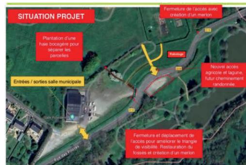
Le 29 septembre 2023, la Commission de Sécurité Routière a émis quelques recommandations concernant la RD18 à hauteur du plan d'eau. Elle confortait l'idée qu'il fallait neutraliser la sortie face au parking du plan d'eau.
